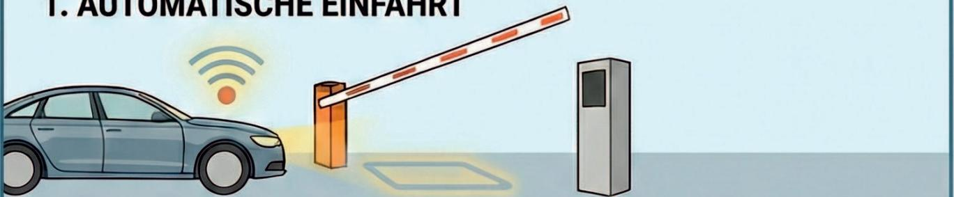
Einfahrt frei. Schranke öffnet automatisch durch Bodenschleife oder Radarsensor.
