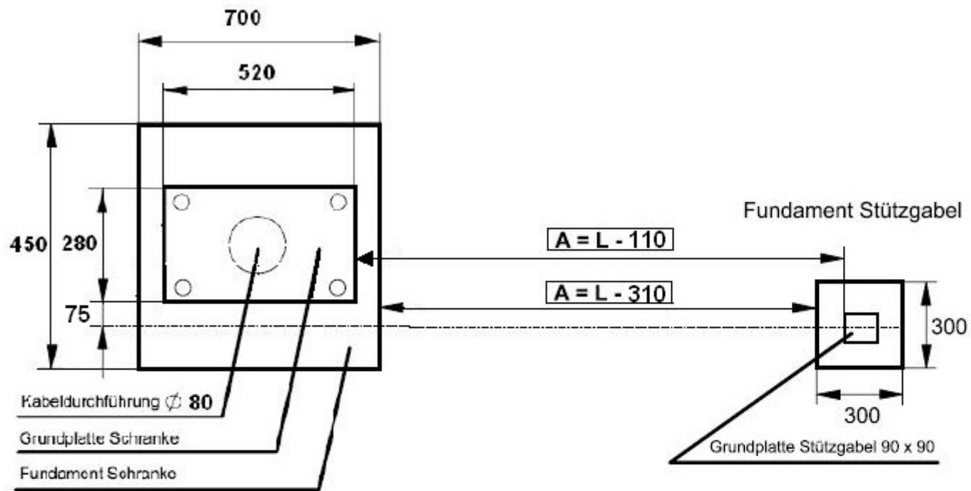
**Achtung, bei dem 7m Balken müssen bei den Abständen A 300mm dazugerechnet werden**
